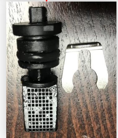
Под датчиком протока ГВС находится фильтр ГВС (размер ячейки 1.5мм)
