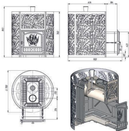
Закрытая каменка из нержавеющей стали толщиной 4 мм размещена внутри топки. Это позволяет получать из печи отличный мелкодисперсный пар для создания режима русской бани.
