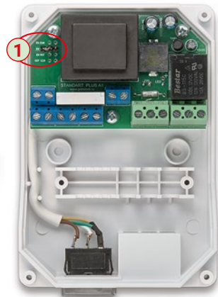
Фото 2. Блок управления GIDROLOCK STANDARD со снятой крышкой. (1) — штыревой разъем, с помощью переключки (джампера) которого можно изменять функционал блока управления
