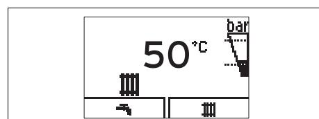
Основная индикация отображает текущее состояние изделия. При нажатии клавиши на дисплее будет показана активированная функция.
