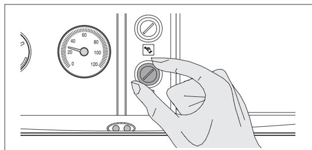
**⚠** Если датчик тяги срабатывает слишком часто, следует проверить, не засорился ли дымоход и правильно ли он изготовлен.
