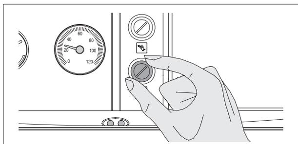
**⚠** Если термостат вывода продуктов сжигания повторно вступает в действие, проверить, чтобы в выпускном трубопроводе продуктов сгорания не было закупорок, а также правильность его конструкции.
