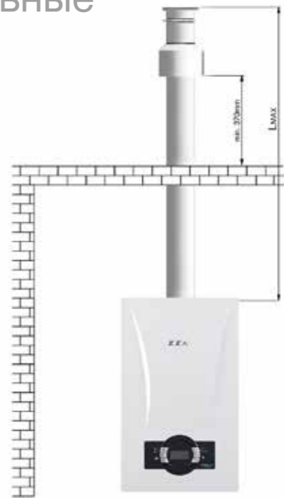
Вертикальный коаксиальный дымоход Максимальная высота L макс.: 10 м, Ø60/100 Максимальная высота L макс.: 20 м, Ø80/125
