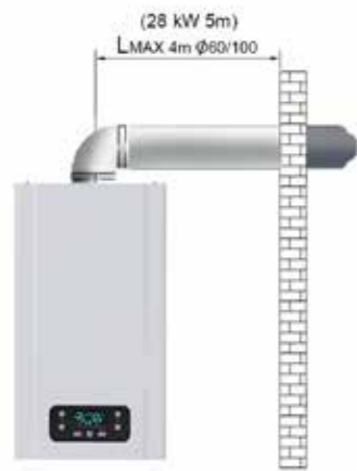
Горизонтальная система дымоудаления (Lмакс. расстояние с одним коленом: 4 м, Ø60/100) (Lмакс. расстояние с одним коленом: 6 м, Ø80/125)
