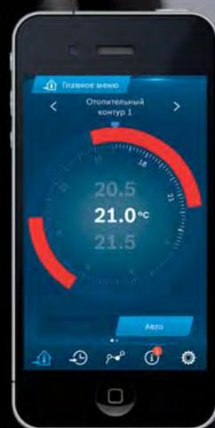
Buderus Logamatic Web KM200 – предназначен для удалённого управления котлом при помощи смартфона, работающего на системе Android или iOS. Работает с котлами через шину EMS-bus. Бесплатное приложение Buderus Easy Control можно загрузить с App Store или Android market.
