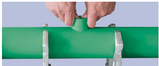
④ Нагретое седло установите в нагретое отверстие и зафиксируйте. Спустя час систему можно заполнить водой и подвергать воздействию давления.
