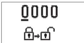
Используя клавиши (+) и (-) производится выбор цифры, которую необходимо изменить, для подтверждения нажать клавишу (✓). Когда цифра начнет мигать, ее можно изменить с помощью клавиш (+) и (-), затем подтвердить ее с помощью клавиши (✓). После того, как будет введен правильный код, регулятор разблокирует параметры и вернет к выбранной группе параметров. Для выхода из меню ввода кода для разблокировки необходимо нажать клавишу (←).
