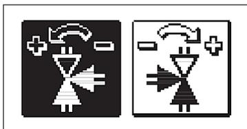
В меню выбора направление открытия смесительного клапана, выбор производится с помощью клавиш (+) и (-). Выбранное направление подтверждается нажатием клавиши (✓).
